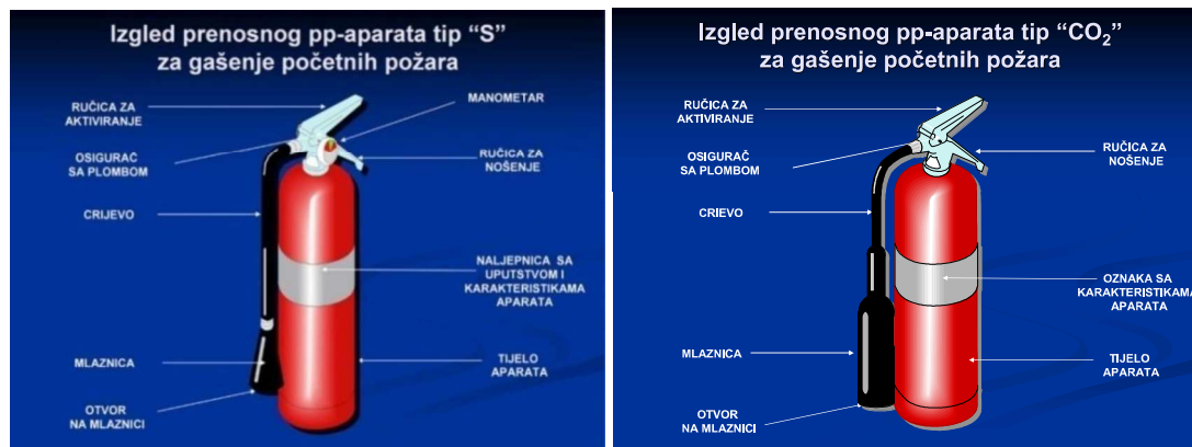
Slika 4. Izgled ručnog prenosnog aparata za početo gašenje požara, tip S-9A i CO 2 -5 kg
